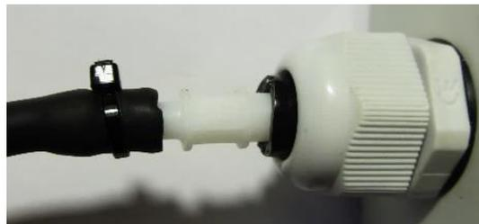
nécessaire, tirer sur les embouts afin que le tuyau ressorte légèrement des presses étoupes. Serrer les presses étoupes. (Si un presse étoupe tourne et ne permet pas un serrage correct, serrer l'écrou à l'intérieur du coffret si nécessaire)
