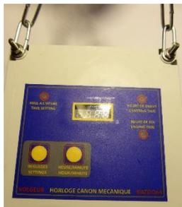
les 4 vis avec un ensemble rondelle + écrou. A l'aide de la chaîne, positionner le coffret comme indiqué sur la photo : dans cette position, la façade sera protégée du soleil et des intempéries. Les vis sont suffisamment longues pour éviter tout frottement du lexan avec les cordons de soudure des bouteilles de gaz.
